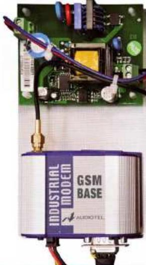
Modelele LM 14 – 18 – 23 sunt dotate ca standard cu sistem **GSM Modem** ce asigură controlul și diagnosticarea mașiniilor de la distanță. Acest sistem GSM Modem comunică prin SMS direct cu serverul central IMESA.
